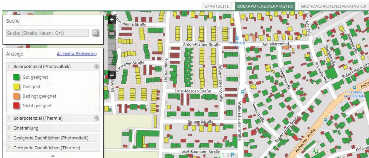
Abbildung 7: Auszug Solarpotenzialkataster für den Landkreis Aichach (<https://www.solare-stadt.de/Aichach/>)
